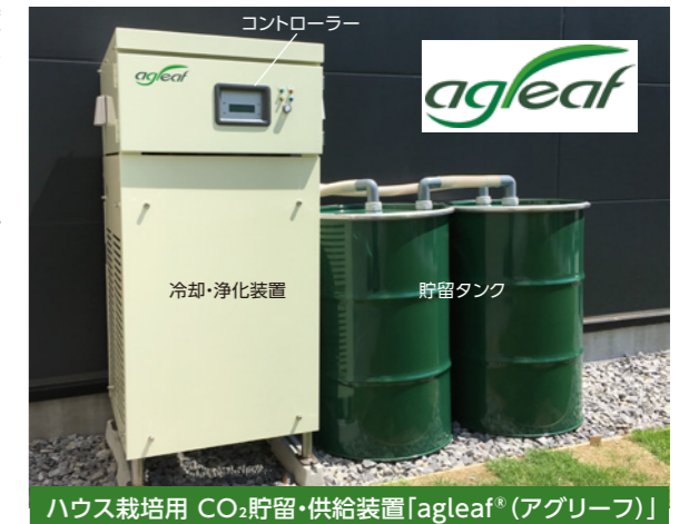
ハウス栽培用 CO 2 貯留・供給装置「agleaf®(アグリーフ)」
